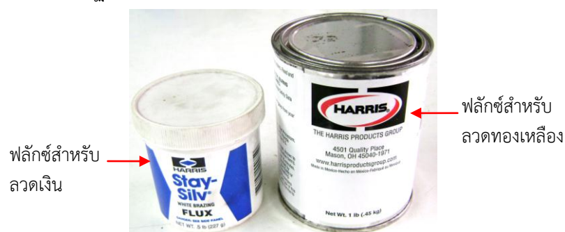
รูปที่ 2.3 แสดงลักษณะชนิดฟลักซ์บัดกรีแข็ง
